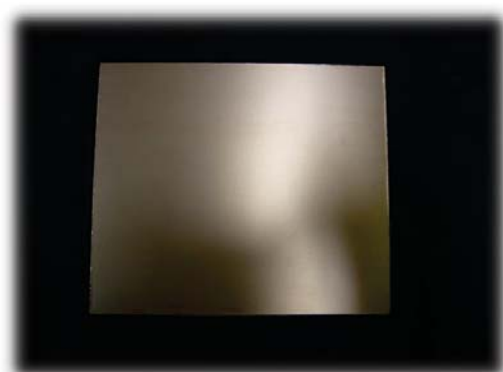
銅張積層板 CCL (copper clad laminate)
